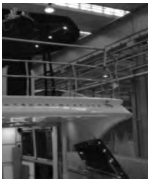
Protection contre les chutes de hauteur - Monte Carlo Yacht
