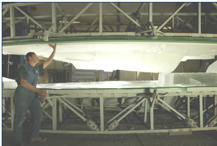
Technique d'injection en moule fermé
